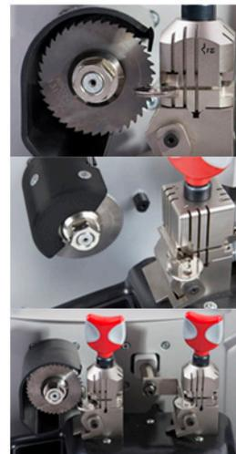
Ninja es la primera y única duplicadora electrónica compacta de alta precisión para llaves planas de lado simple y doble con función de corte de código, copia y decodificación.
