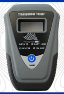
El probador de transponder TDB002 ofrece una sencilla solución para ver si una llave o mando a distancia tiene un transponder. también es una manera rápida y fácil de comprobar si el transponder está respondiendo.
